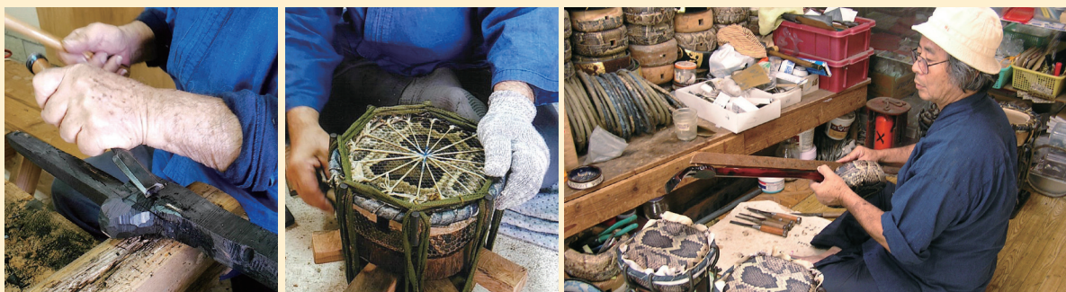
■三線の製作工程。左から、棹の鳩胸の加工。胴(チーガ)の木棹に沿って蛇皮を張りクサビで張り具合を調整する「蛇皮張り」。一番右は棹にカラクリを付けてチーガに差し込む「部当て(ブーアティ)」、原木の製材・裁断から削り出し、すべて手作業で仕上げます
